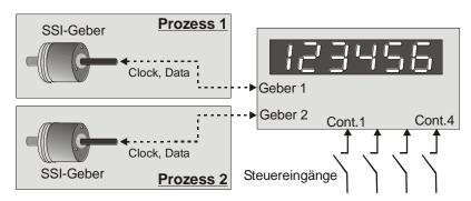
An beiden Gebereingängen ist jeweils ein SSI-Geber angeschlossen. Die Geber werden unabhängig voneinander ausgewertet und können unterschiedliche Bitzahlen und Skalierungen aufweisen.
