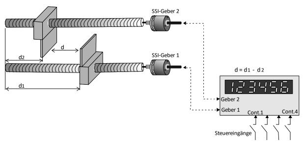
An beiden Gebereingängen ist jeweils ein SSI-Geber angeschlossen. Das Gerät bildet die Differenz der beiden Geberpositionen. Jeder Geber kann zunächst einzeln skaliert werden und das Endergebnis kann danach nochmals endgültig skaliert werden.
