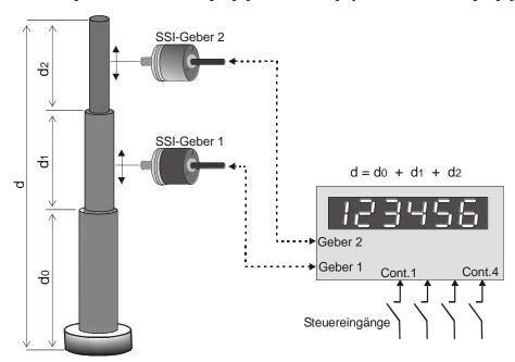
An beiden Gebereingängen ist jeweils ein SSI-Geber angeschlossen. Das Gerät bildet die Summe der beiden Geberpositionen. Jeder Geber kann zunächst einzeln skaliert werden und das Endergebnis kann danach nochmals endgültig skaliert werden.
