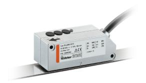
Das berührungslose absolute magnetische Längenmesssystem Limes LA50 / BA5 – bestehend aus dem Sensorkopf LA50 und dem Magnetband BA5 – ermöglicht eine Auflösung bis zu 10 μm bei einem maximalen Abstand von 1,5 mm zwischen Sensor und Band.
