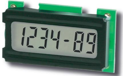
Le module compteur horaire 194 à monter sur circuit imprimé offre un affichage à cristaux liquides à 6 digits et 2 plages de tensions (4,75 ... 15 V DC et 9 ... 60 V DC).
