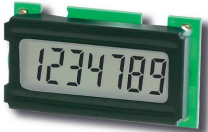
Das einkanalige Zählmodul Typ 190 für Leiterplatten-Montage mit 2 Spannungsbereichen (4,75 ... 15 und 9 ... 60 V DC) und 7-stelliger, großer LCD-Anzeige verfügt über einen sehr großen Temperaturbereich.
