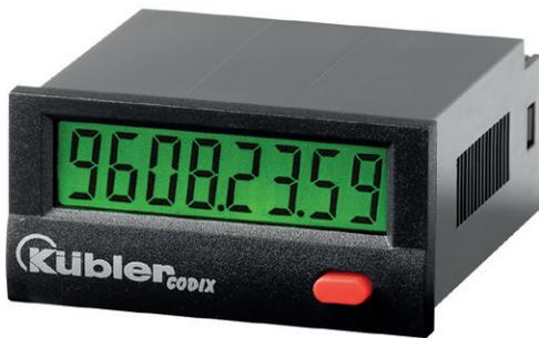
Der Codix 135 ist ein batteriebetriebener einfacher Betriebsstundenzähler für PNP, NPN und Hochvoltanwendungen. Verschiedene Zeitbereiche werden über die 8-stellige LCD-Anzeige mit optionaler Hinterleuchtung dargestellt.
