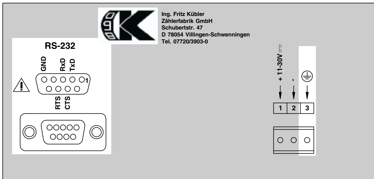
Anschlußbuchse für die serielle Schnittstelle von reporter 670.
