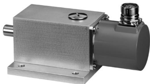
Les charges axiales ou radiales admissibles sur les arbres des codeurs sont généralement dépassées dans le cas d'un entraînement des codeurs par des roues dentées ou des roues à chaîne, des courroies trapézoïdales ou crantées, des roues de mesure, etc. Ce palier, équipé de roulements renforcés, est parfaitement adapté à ces utilisations.
