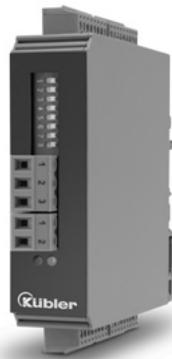
Der Signalsplitter SP 2D-2D ist ein universelles Encoder-Interface (ohne Potenzialtrennung) mit 2 inkrementellen Geberingängen zur Pegelumsetzung, Verteilung sowie kontaktlosen und prellfreien Umschaltung von Geber-Signalen im HTL- oder RS422-Format.
