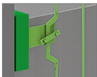
Déclencheur mécanique du parachute
