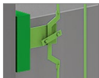
Mechanischer Auslöser der Fangvorrichtung
