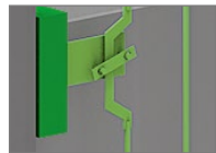
Déclencheur mécanique du parachute
