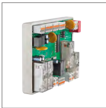
Kübler Auswerteeinheit PSU02 (im Schaltschrank) (alternativ an der Aufzugskabine)
