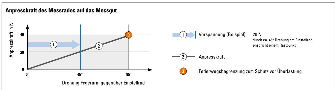
**Performance-Line**      **Messradsystem MWE61**      **Mit Federarm, Anpresskraft max. 40 N**
