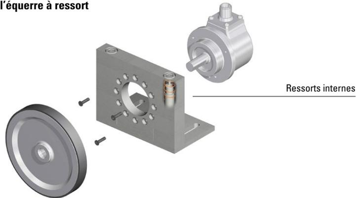
Pour une direction de sortie de câble flexible, le codeur peut être monté en plus par pas de 30°.
