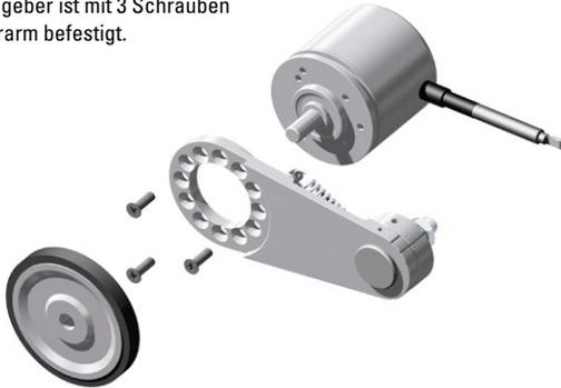
Die Befestigungspunkte sind so ausgelegt, dass eine beidseitige Montage am Federarm möglich ist.
