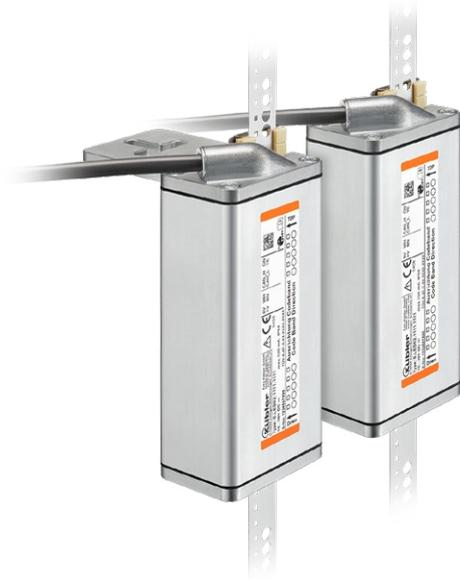
Ants LEB02 est un système de mesure extrêmement robuste, compact et sans contact. Grâce à son principe de mesure sans contact, il mesure, sans glissement, les positions absolues de la cabine avec une résolution de 1 mm et une vitesse de déplacement de 8 m/s. Les composants supplémentaires comme les commutateurs magnétiques ne sont plus nécessaires. Son montage simple et aisé réduit le temps d'installation, contribuant ainsi à la réduction des coûts globaux.
