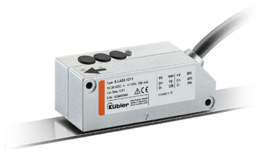
Le système de mesure linéaire magnétique absolu sans contact Limes LA50 / BA5 - composé du capteur LA50 et de la bande magnétique BA5 - atteint une résolution de 10 µm avec une distance maximale de 1,5 mm entre le capteur et la bande
