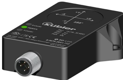
Mit den Neigungssensoren der Typenreihe IN78 werden 2-achsige Neigungen im Messbereich von  $\pm 85^\circ$  oder 1-achsige Neigungen bis  $360^\circ$  über eine Sensorfusion aus Beschleunigungs- und Drehratenmesszelle (Gyroskop) ermittelt. Für individuelle Anforderungen lassen sich unterschiedliche Parameter (z.B. über die Software PACTware) kundenspezifisch anpassen. Durch ihre hohe Robustheit sind die Neigungssensoren auch für den Einsatz im Außenbereich bestens geeignet.
