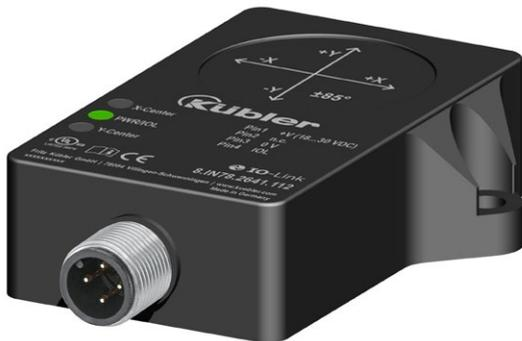
Les inclinomètres de la série IN68 permettent de déterminer des inclinaisons à 2 axes dans une plage de mesure de  $\pm 85^\circ$  ou des inclinaisons à 1 axe jusqu'à  $360^\circ$  via une cellule d'accélérométrie. Pour les exigences individuelles, il est possible d'adapter différents paramètres (p.ex. via le logiciel PACTware) de manière spécifique au client. Grâce à leur grande robustesse, les inclinomètres sont également parfaitement adaptés à une utilisation en extérieur.
