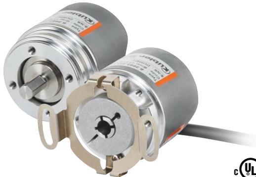
Le codeur Sendix F36 avec la technologie brevetée Intelligent Scan™ est un codeur multitours optique sans engrenage et insensible à 100% aux champs magnétiques – au format miniature. Il ne mesure que 36 x 42 mm et est équipé d'un arbre creux traversant jusqu'à 8 mm ou d'un arbre creux borgne jusqu'à 10 mm.
