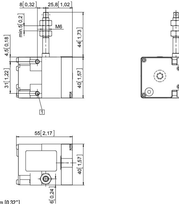
1 2 x M4, profondeur de vissage max. 8 mm [0.32"]
