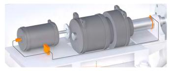
2 – Durch zwei inkrementale Drehgeber an unterschiedlichen Messstellen im Antriebs-strang. Hierbei kann zusätzlich die Differenz zwischen Rotorund Generatorwelle auf Schlupf- oder Getriebebruch überwacht werden.
