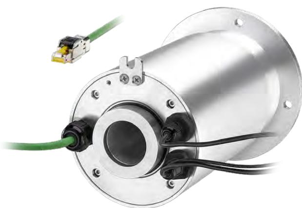
Neben der Übertragung elektrischer Ströme sowie Flüssigkeiten und Gase lassen sich weitere Funktion zur Geschwindigkeits-, Positions- oder Temperaturüberwachung in das Schleifringkonzept integrieren. Wie z. B. Kübler inkrementale und absolute Drehgeber oder lagerlose Drehgeber.
