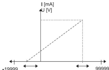
Anzeigewert innerhalb des Anzeigebereichs frei verschiebbar
