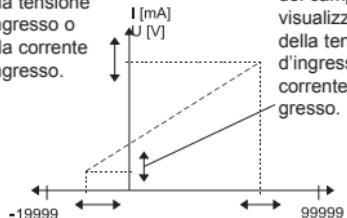
La tensione d'ingresso minima o la corrente d'ingresso minima possono essere spostate liberamente all'interno del campo di visualizzazione della tensione d'ingresso o della corrente d'ingresso.
