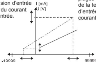
La tension minimum en entrée ou le courant minimum en entrée peuvent être déplacés librement dans les plages d'affichage de la tension d'entrée ou du courant d'entrée.
