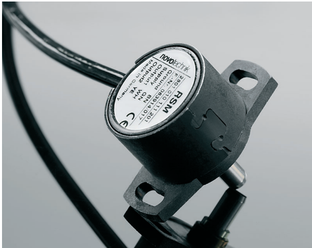
Der auf dem GMR-Effekt basierende Multiturn-Sensor von Novotechnik kann zusätzlich zum Drehwinkelsignal im stromlosen Zustand ohne Pufferbatterie und ohne Getriebe derzeit bis zu 16 Umdrehungen zählen und dauerhaft speichern. Die nächste Generation wird sich für über 4 000 Umdrehungen eignen
