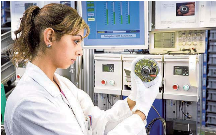
Erste Qualitätskontrolle: Fatma Colak schaut sich den Drehgeber genau an. BILD: KÜBLER
