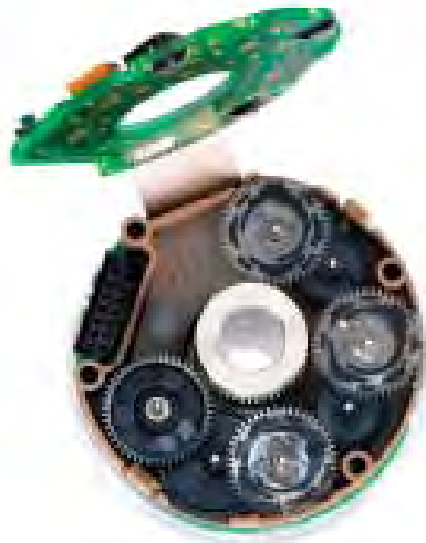
Mechanischer Multiturn-Drehgeber mit durchgehender Hohlwelle bis 14 mm
