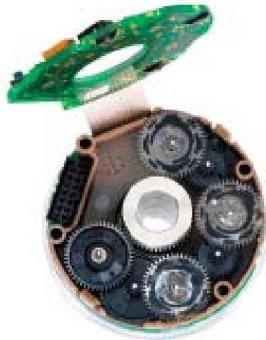
Mechanischer Multiturn-Drehgeber mit durchgehender Hohlwelle bis 14 mm
