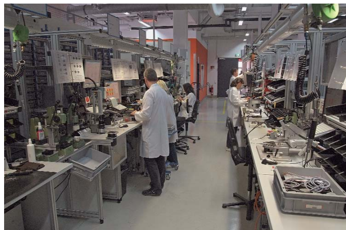
Blick in die neue Fertigung bei Kübler nach dem One-Piece-Flow-Prinzip. Die Mitarbeiter begleiten einzelne Produkte durch die Stationen ihrer Fertigungsinseln – bis hin zur Verpackung. Rote Aufkleber verweisen auf Optimierungspotenzial. Links hinter den Arbeitstischen das Komponentenlager in Reichweite. (Foto: Kübler)
