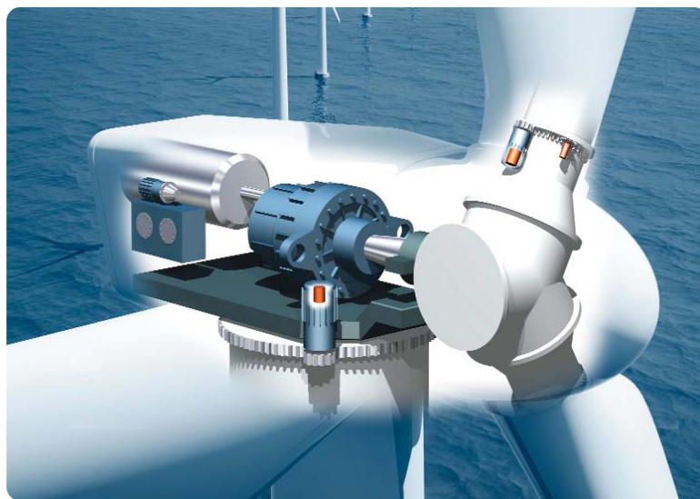
Bild 2: In Windanlagen wird eine redundante Überwachung der Drehzahl gewünscht. Kübler bietet Tacho-Frequenzanzeigen zur Differenzüberwachung von Rotornaben- und Generator-drehzahl mit sicheren Relaiskontakten zur Unterbrechung der Sicherheitskette an.
