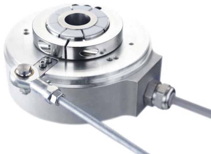
Bild 3: Kübler bietet Drehgeber mit seewasserresistenter Beschichtung der Gehäuseteile und IP67-Schutzart an. Getestet sind die offshore-tauglichen Geber nach den höchsten Anforderungen der Norm IEC68-2-11: Über eine Zeitspanne von 672h in der Salzsprühkammer.
