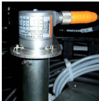
Positions- und Drehzahlgeber, wie hier zur Lenkwinkelüberwachung fahrerloser Transportsysteme, arbeiten auf sehr beengtem Raum. Die Fahrzeuge müssen kompakt gebaut sein, um Lagerkapazitäten zu schonen und Transportwege kurz zu halten.
