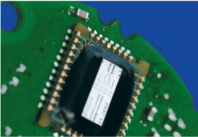
Das Herzstück des Sensors, der Sendix-Absolutdrehgeber basiert auf hoch integrierter Asic-Technologie.
