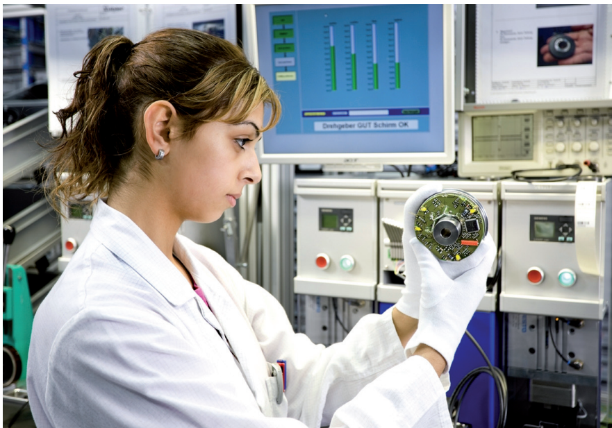
Geschulte Augen sehen mehr. Ein erster und wichtiger Bestandteil des mehrstufigen Prüfprozesses von Drehgebern ist und bleibt der Sichttest.
