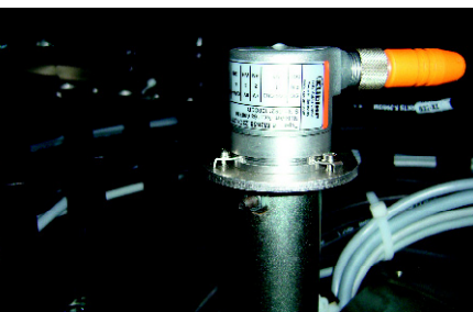
Absolut-Drehgeber der Baureihe Sendix M36 messen die Winkelstellung der Lenkachse
