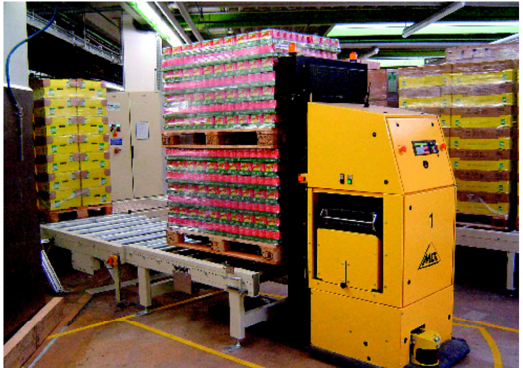
Mit dem FTS vom Typ Phoenix R können die Lasten an höher gelegenen Stellplätzen aufgenommen und abgesetzt werden
