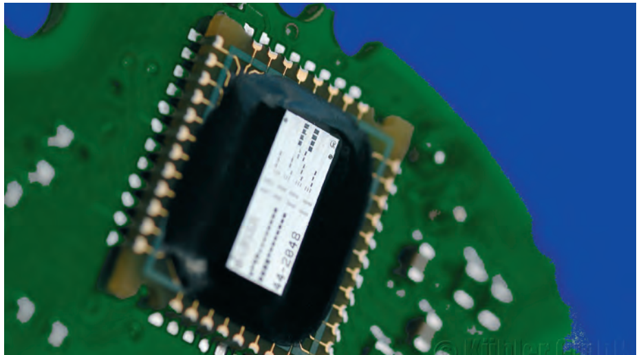
2: Das Sensor-Herzstück der Sendix absolut-Baureihe: hochintegrierte ASIC-Technologie
